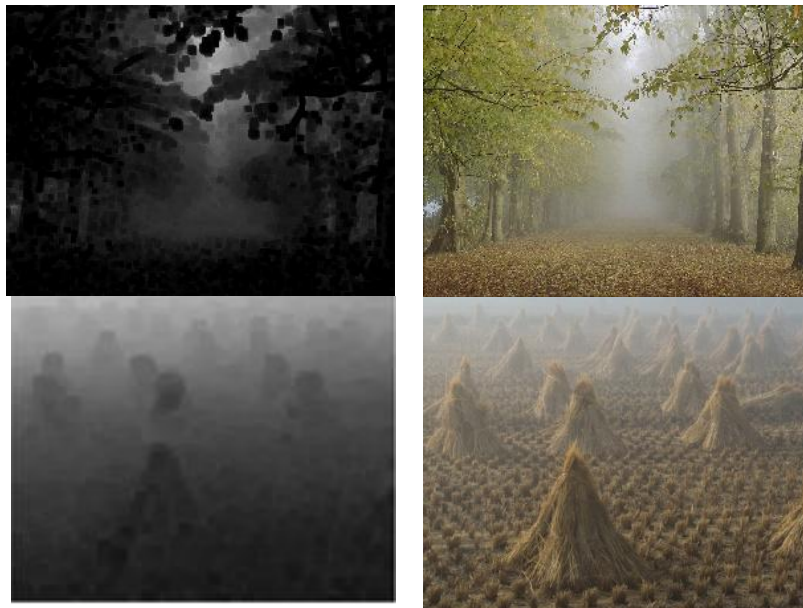
الف) تصویر آغشته به مه ب) کانال تاریک تصویر (الف) شکل (۱-۳): تصویر آغشته به مه به همراه کانال تاریک آن.
