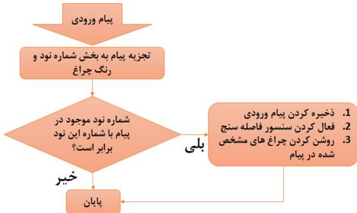
شکل (۳-۱۷): عملکرد میکروکنترلر Atmega8 موجود در گره جانبی هنگام دریافت پیام
