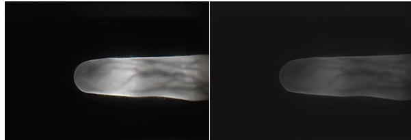
شکل (۲-۳) تصویر اصلی و تصویر نرمال شده (الف) تصویر رگ‌انگشت اصلی (ب) تصویر رگ‌انگشت نرمال شده [۱۶]
