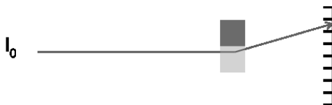
شکل ۹-۲: شمایی ریشه اثر پراکندگی. اشعه با شدت I_0 که پس از برخورد به شیء از مسیر اصلی منحرف می‌شود و به گیرنده دیگری برخورد می‌کند.
