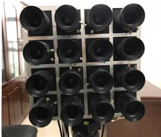
شکل ۱-۲: نمونه‌ای از آرایه 4 \times 4 از دوربین‌ها. تصویر از مرجع [۳] اخذ شده است.
