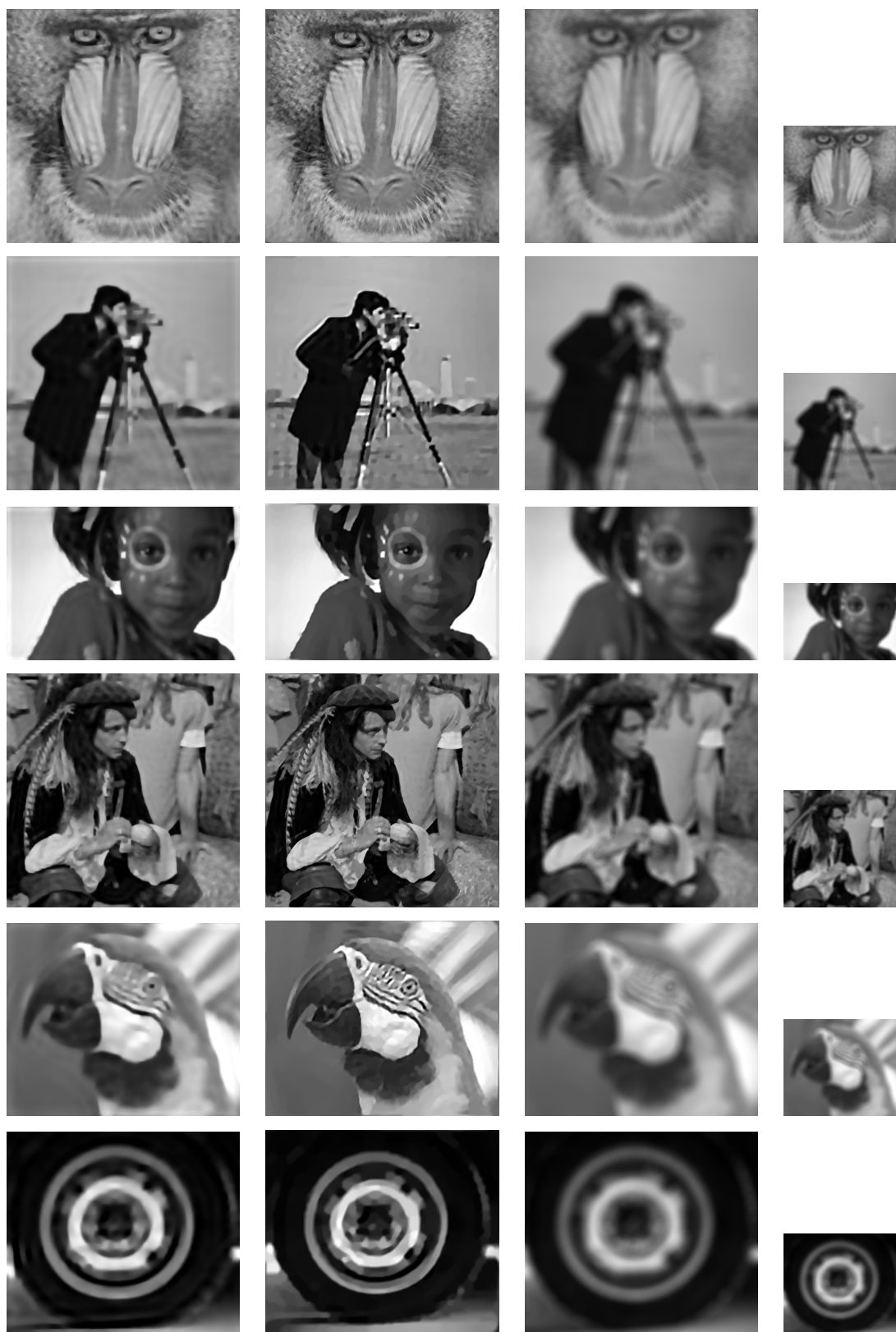
شکل ۴-۵: مقایسه نتایج روش پیشنهادی با [90^\circ] بر روی داده‌های تار شده با هسته‌ی تار 15 \times 15 . ستون‌ها به ترتیب از راست به چپ عبارتند از نمونه‌ای از تصویر LR، تصویر HR، خروجی روش پیشنهادی، خروجی روش [90^\circ] . تصاویر اصلی در شکل ۱-۵ نمایش داده شده است.
