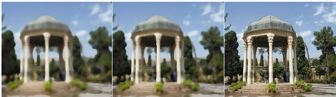
الف) تصویر ورودی ب) نتیجه اعمال فیلتر میانه با اندازه پنجره 5 \times 5 ب) نتیجه اعمال فیلتر میانه با اندازه پنجره 7 \times 7
