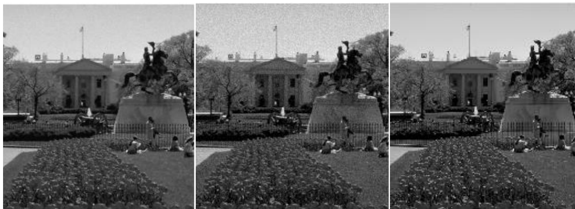
الف) تصویر عاری از نویز ب) تصویر آغشته به نویز گوسی پ) تصویر رفع نویز شده شکل (۳-۹) نتیجه فیلتر انتشار برای رفع نویز گوسی با روش قطعه‌بندی
