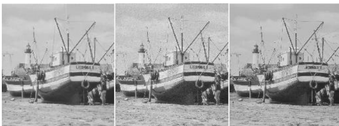
الف) تصویر عاری از نویز ب) تصویر آغشته به نویز تصادفی پ) تصویر رفع نویز شده شکل (۳-۱۰) نتیجه فیلتر وینر تطبیقی برای رفع نویز تصادفی با روش قطعه‌بندی
