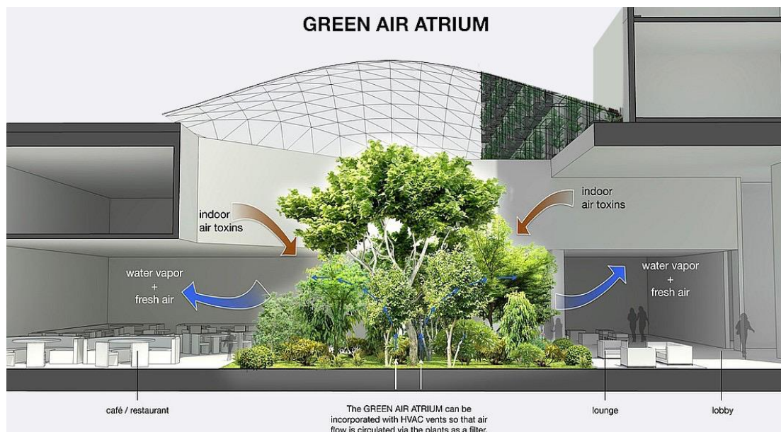
شکل ۶۷: نقش تراریوم در تعدیل دمای فضای داخلی (منبع: نگارنده)
