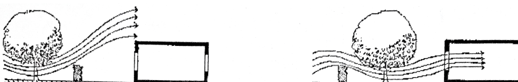
شکل ۵-۷ نحوه جریان باد نسبت به موقعیت بادشکن و یک درخت (اخترکاو و صدیق، ۱۳۹۱، ص. ۶۱)
