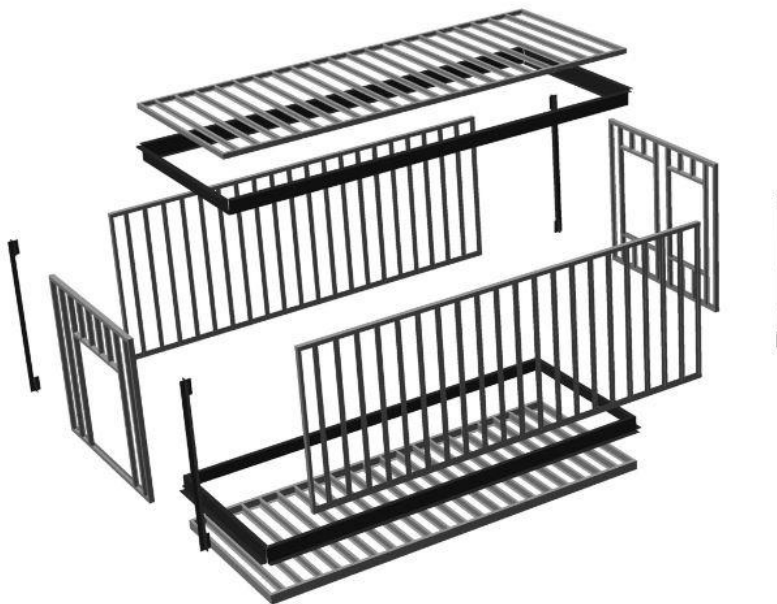
تصویر (۲-۷) - عناصر تشکیل دهنده مدول فلزی [۲۷]
