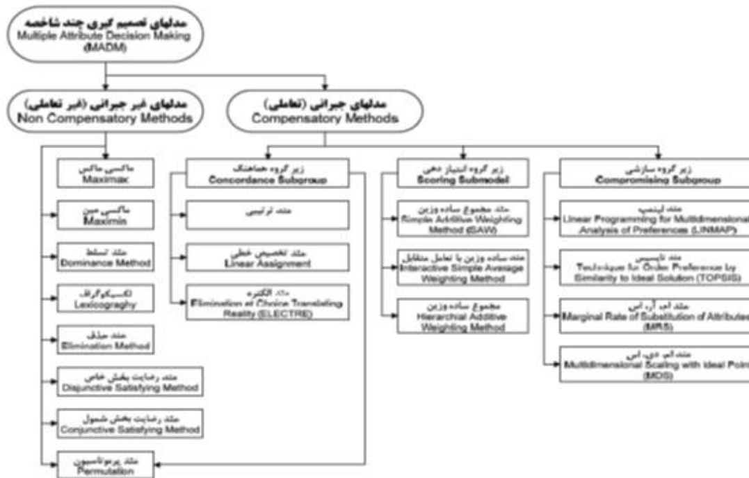
شکل ۲-۱۴: دسته‌بندی انواع مدل‌های تصمیم‌گیری چندشاخصه از نظر پردازش اطلاعات
