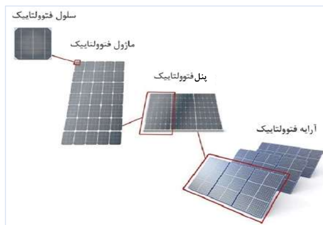
شکل ۲-۲ اجزاء یک سیستم‌های فتوولتائیک
