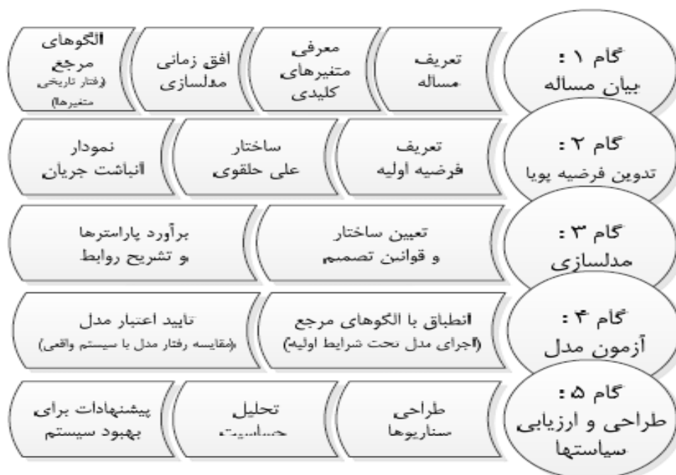
شکل (۳-۵). روش پویایی‌های سیستم بر اساس روش استرمن
