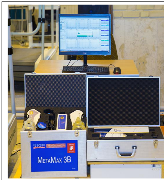
شکل شماره ۵: دستگاه گاز آنالیزر
