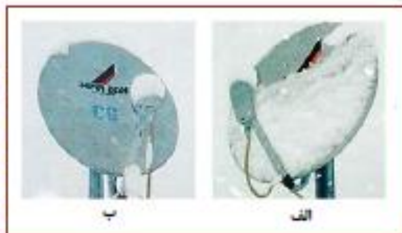
شکل ۲. محافظت سیستم‌های دریافت و ارسال امواج ماهواره‌ای با رنگ‌های ضدآب، نسبت برف نشسته شده بر روی سطح پوشش داده شده با رنگ ضدآب (ب) در مقایسه با سطح پوشش داده نشده بسیار ناچیز است [۱].
