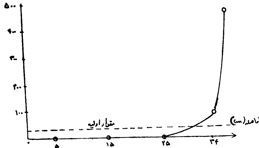
شکل ۲- تغییرات غلظت نقره در میله‌ای از قلع برحسب فاصله از سر میله و بعد از ۹ بار تکرار
