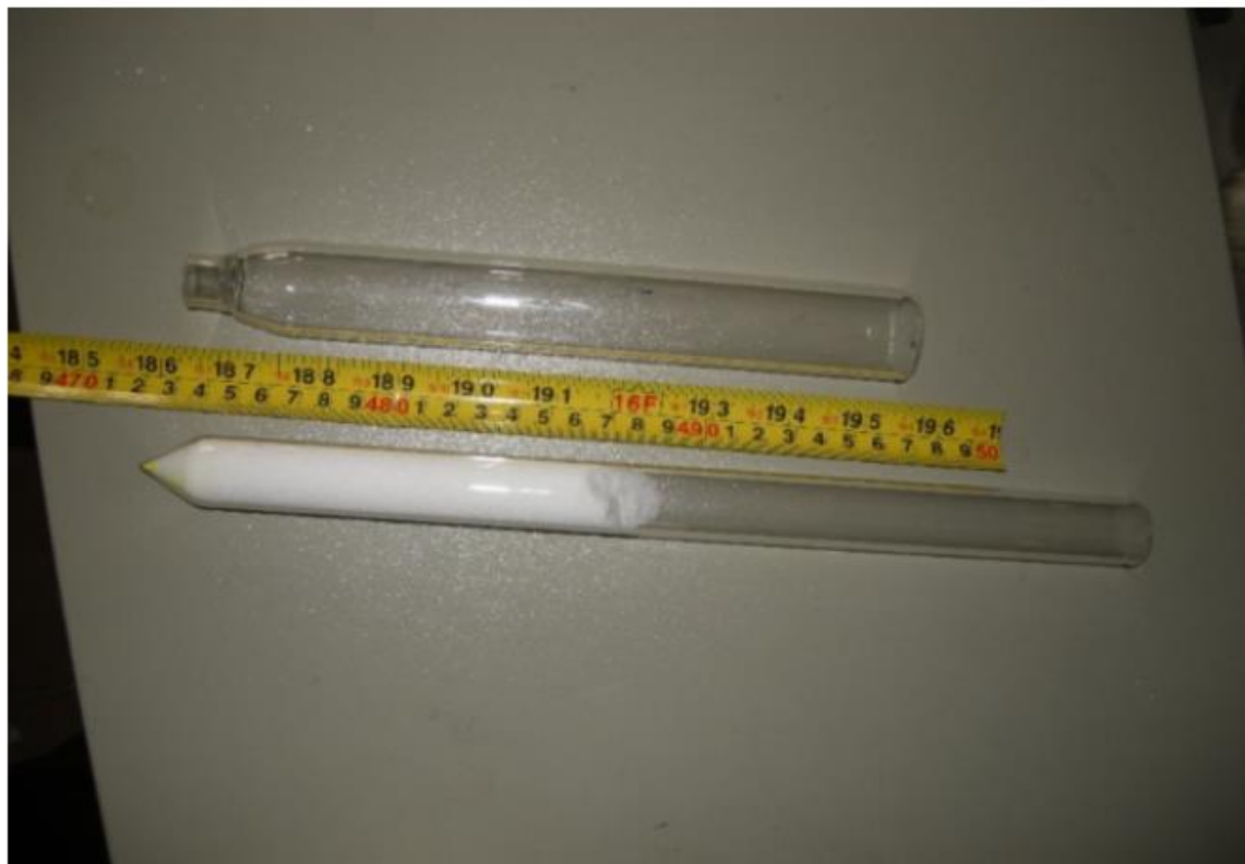
شکل ۳ لوله کوارتز دربردارنده ماده CSI با نوک مخروطی ۹۰ درجه همراه با نگهدارنده آن از جنس کوارتز .
