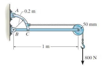
تمرین۵: در جرثقیل هیدرولیکی نشان داده شده نیروی جک AB و اعضای AC و بیابید. وزن بار ۱۴۰۰ پوند است.
