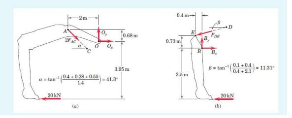
تمرین ۱: به کمک یک انبردست و با نیروی  $\lambda \cdot \lambda$  نیوتن یک میلگرد فشرده میشود. نیروی اعمالی به میلگرد و همچنین نیروی وارد شده به پین A را بیابید.
