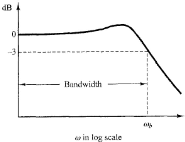
دیاگرام بود سیستم مدار باز
