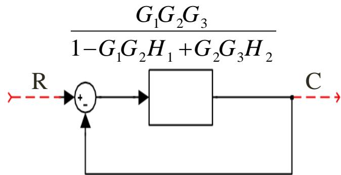
$$G(s) = \frac{C(s)}{R(s)} = \frac{G_1 G_2 G_3}{1 - G_1 G_2 H_1 + G_2 G_3 H_2 + G_1 G_2 G_3}$$
