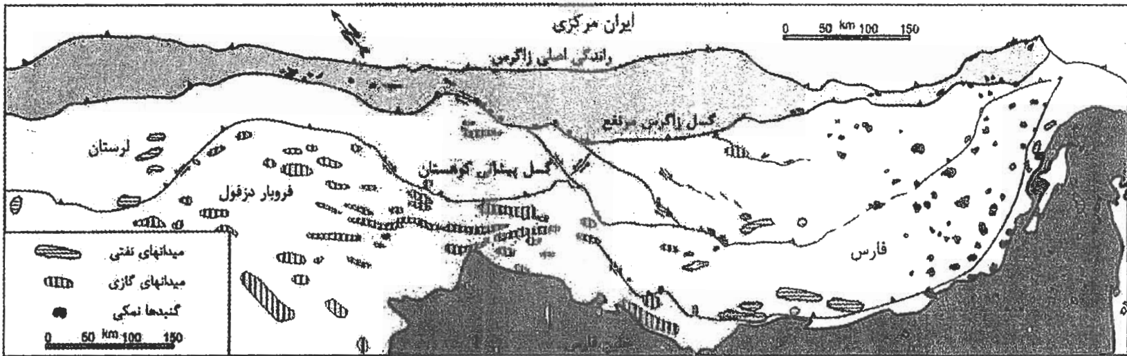
شکل ۱۵-۱۷. ساختار کمربند چین خورده- رانده زاگرس. الف) نمایش زون های گسلی اصلی، توزیع میدان های نفت و گاز و گنبد های نمکی؛ ب) مدل ساختاری زاگرس، نشان دهنده نقش مهم گسل های امتداد لغز کارزون، ایذه، بالارود و منقارک در توسعه وضعیت کنونی زاگرس (سپهر و کاسگرو، ۲۰۰۴ و ۲۰۰۵).
