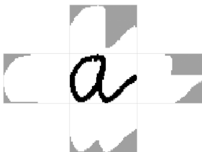
شکل (5-8): محاسبه فاصله بین پیکسل‌های تصویر کاراکتر و لبه آن.
