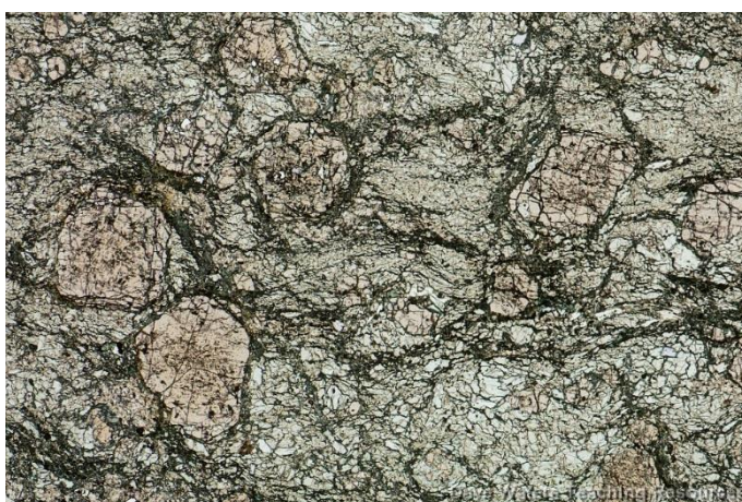
مقطع نازک اکلوژیت که با حضور گارنت و پیروکسن از نوع امفاسیت مشخص می‌گردد.
