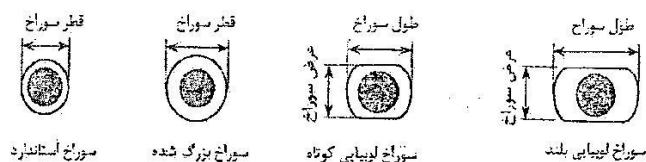
شکل ۱-۴- انواع سوراخ پیچها در اتصالات پیچی
