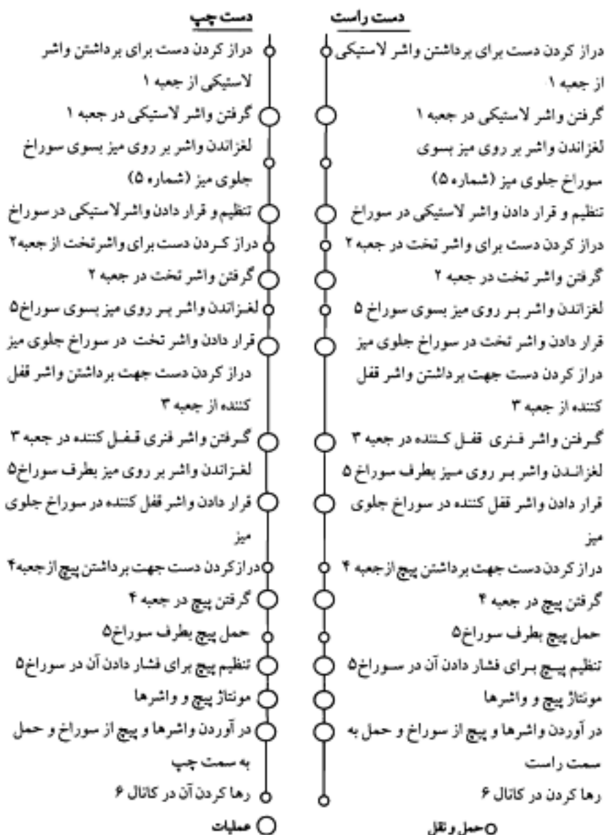
شکل ۷-۳ نمودار عملیات دست راست و چپ برای مونتاز پیچ و واشرها به روش بهبود یافته
