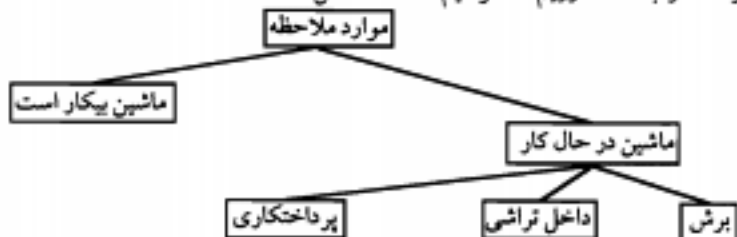
شکل ۴-۲۹- تحلیل نوع کار ماشین در روش نمونه برداری از کار
