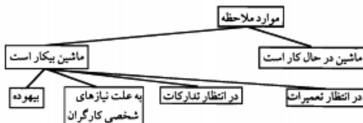
شکل ۲-۲۸- تحلیل دلایل بیکاری ماشین در روش نمونه برداری از کار
