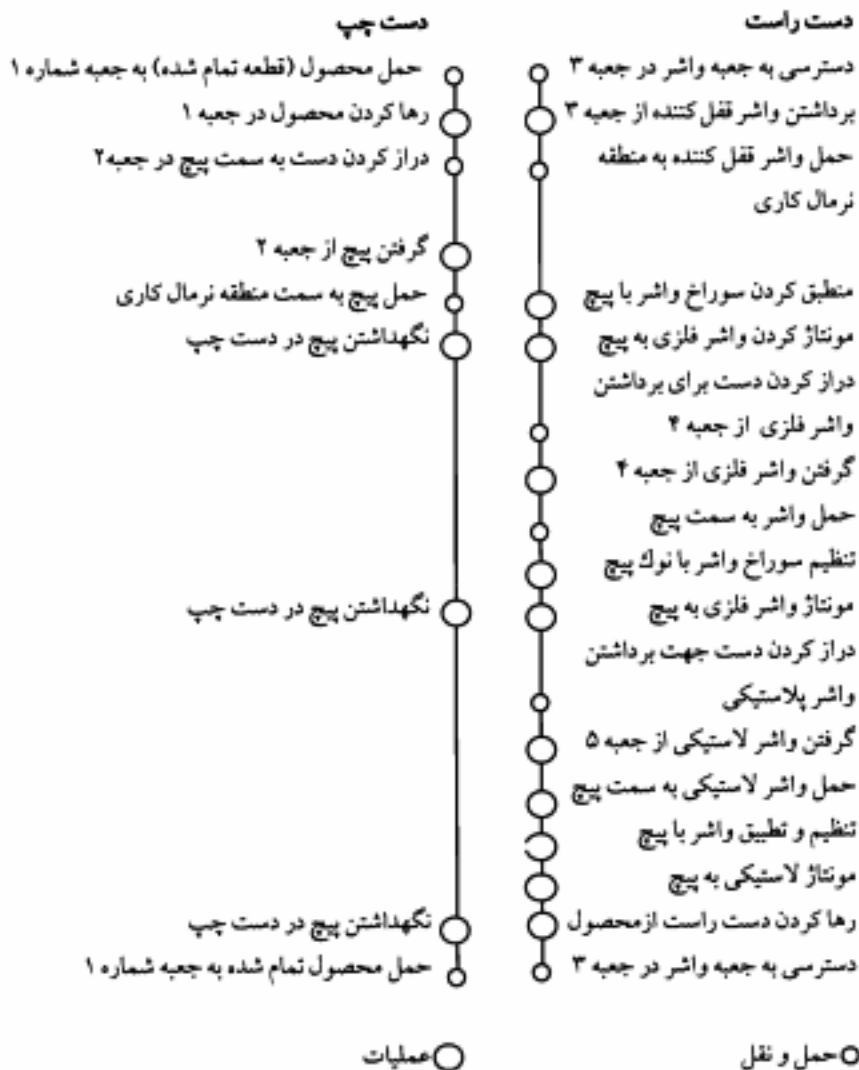
شکل ۳-۶ نمودار عملیات دو دست برای مونتاژ پیچ و واشرها به روش قدیم
