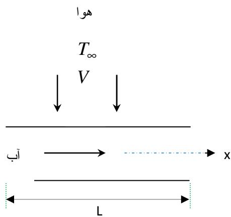
۲۱- در جریان کاملاً توسعه یافته هیدرودینامیکی و گرمایی درون لوله‌ای با دمای سطح ثابت، دمای متوسط آب در دو مقطع بفاصله  $L$  از یکدیگر  $T_{m,i} = 30^\circ C$  و  $T_{m,o} = 80^\circ C$  می‌باشد. گرادیان فشار آب درون لوله
