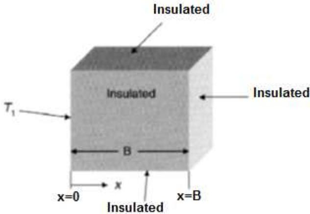
۵- بلوک نشان داده شده در شکل روبرو، از بالا، پایین، جلو، پشت و وجه واقع بر  $x = B$  عایق شده است؛ وجه  $x = 0$  در دمای ثابت  $T_1$  می باشد. درون بلوک، گرما با نرخ تولید می شود. بر حسب وات بر مترمکعب  $\dot{q} = \Gamma e^{-\gamma x}$  و  $\gamma > 0$  مقادیر ثابتی هستند. ماکزیمم دمای حالت پایدار در بلوک را پیدا کنید.
