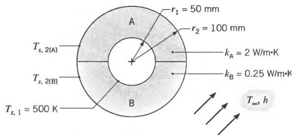
۱- بخار از درون یک لوله بلند جدار نازک، که دمای سطح آن در  $500\text{ K}$  ثابت نگهداشته شده، عبور می کند. این لوله مطابق شکل با پوشش عایقی شامل دو جنس متفاوت  $A$  و  $B$  پوشیده می شود. فرض می شود محل اتصال این دو ماده  $A$  و  $B$  دارای مقاومت تماسی بینهایت است. اگر کل سطح بیرونی در معرض هواست  $h = 25\text{ W/m}^2 \cdot \text{K}$  و  $T_{\infty} = 300\text{ K}$  قرار
