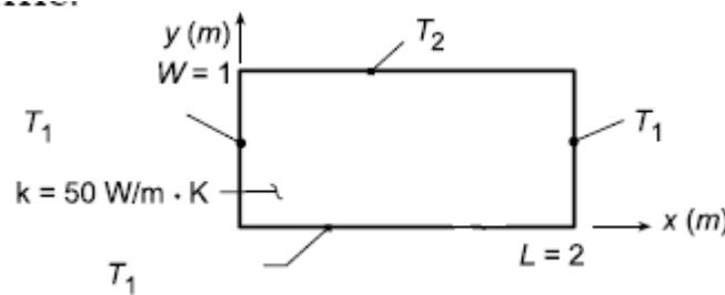
۱۱- مطابق شکل صفحه‌ای به ابعاد  $2\text{m} \times 1\text{m}$  را در نظر بگیرید که دمای وجه بالای آن  $T_2 = 200^\circ\text{C}$  و دمای سه وجه دیگر آن  $T_1 = 60^\circ\text{C}$  است. نزدیک انتقال گرما از وجه پایینی را در واحد ضخامت بر حسب  $\text{W/m}$  حساب کنید (با تقریب چهار جمله‌ی غیر صفر بسط).
