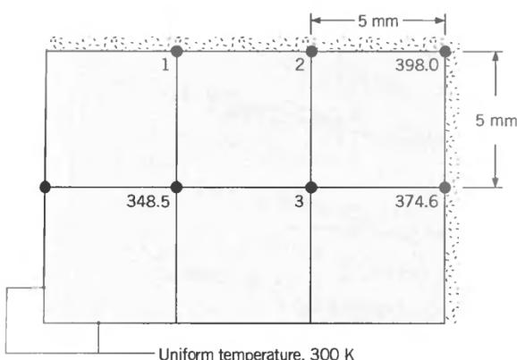
۴- سمت چپ و پایین صفحه ای مطابق شکل زیر، در دمای ثابت  $300\text{ K}$  نگهداشته می شود و سمت راست و بالای آن عایق می باشد. درون این صفحه، تولید انرژی گرمایی یکنواخت  $5 \times 10^7 \text{ W/m}^3$  وجود دارد. ضریب هدایت گرمایی صفحه  $20\text{ W/m.K}$  می باشد. اگر دمای نقطه ۲ برابر  $390.2\text{ K}$  باشد دمای نقطه ۳ را حساب کنید.
