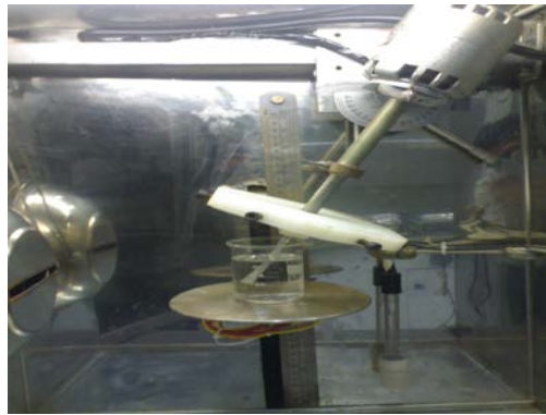
شکل (۱-۳): غوطه وری زاویه ای در روش سل-ژل
