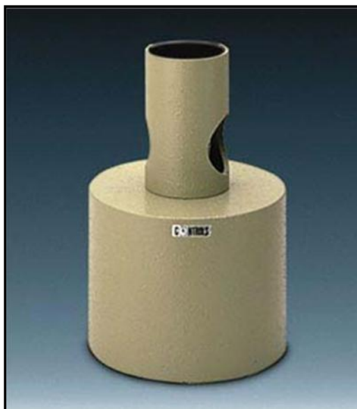
شکل ۲-۱۲- سندان فولادی واسنجی چکش اشمیت
