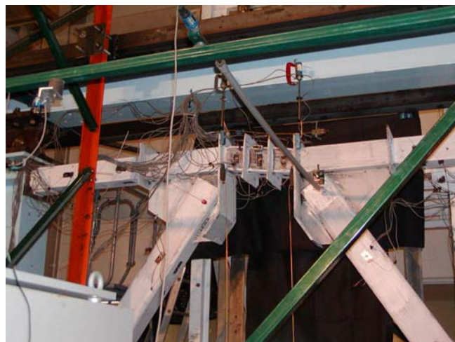
شکل ۸-۲- مدل آزمایشگاهی قاب مهارشده واگرا
