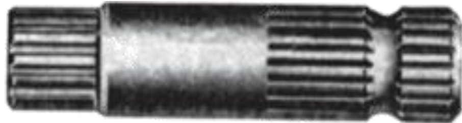
محور پی تی اُ ۲۱ شیار ۱۰۰۰ دور در دقیقه
