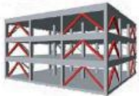
شکل ۴-۱- افزایش مقاومت و سختی سازه بوسیله اضافه نمودن قاب خمشی، مهاربند و دیوار برشی
