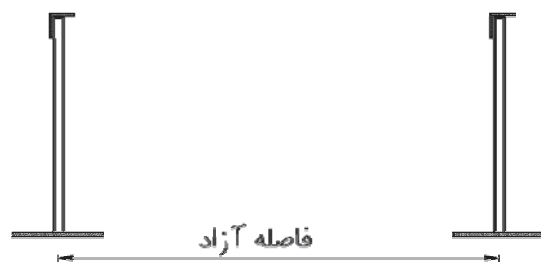
شکل ۸-۲- فاصله‌ی آزاد بین تیرچه‌های فولادی
