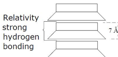
شکل ۱-۸ نحوه پیوند واحدهای پایه کانی کائولینیت
