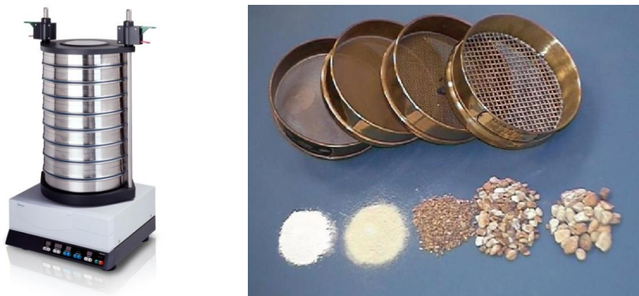
شکل ۱-۱۵ آزمایش دانه بندی مکانیکی با استفاده از سری الک
