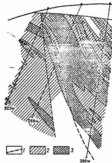
شکل ۴۸- تغییرات مقادیر نسبت ضریبی (چندبارگی) عناصر موجود در بالای توده معدنی (Ag, As, Hg, Sb)، به عناصری که در پایین توده معدنی وجود دارند (Zn, W, Bi, Cu)، که مشخص‌کننده کانسار جیوه (چال بویی) است. ۱- گسل، ۲ و ۳- مقادیر مطلق نسبتهای ضریبی (۲-۰/۰۰۱ تا ۰/۱، ۳- ۰/۱ یا بیشتر).
