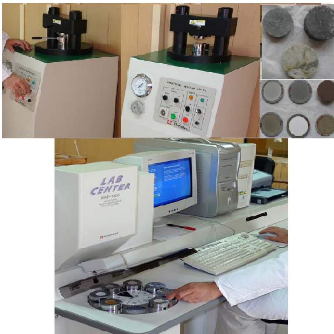
شکل (۱): شمایی از دستگاه پرس نمونه، برخی از نمونه های مورد آنالیز و دستگاه XRF۱۸۰۰ آزمایشگاه تجزیه مواد معدنی دانشکده معدن، نفت و ژئوفیزیک دانشگاه صنعتی شاهرود
