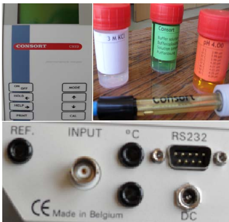
شکل (۴): شمایی از دستگاه تجزیه آب Consort بهمراه برخی از محلولهای استاندارد آزمایشگاه تجزیه مواد معدنی دانشکده معدن، نفت و ژئوفیزیک دانشگاه صنعتی شاهرود
