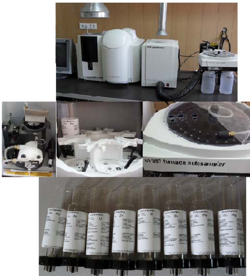
شکل (۳): شمایی از دستگاه جذب اتمی، سیستم شعله و کوره گرافیتی به‌همراه برخی از لامپهای هالو کاند دستگاه - آزمایشگاه تجزیه مواد معدنی دانشکده معدن، نفت و ژئوفیزیک دانشگاه صنعتی شاهرود
