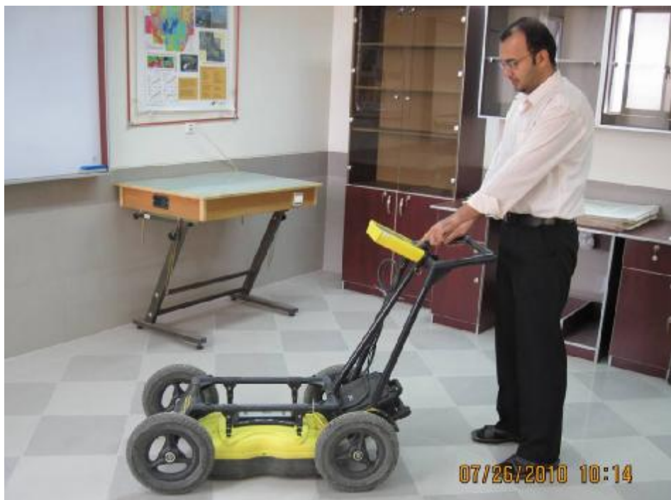
نمایی از دستگاه GPR-Noggin plus به همراه متعلقات آن در مجموعه آزمایشگاههای ژئوفیزیک دانشگاه صنعتی شاهرود
