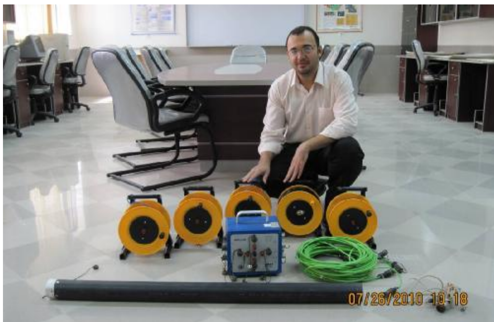
نمایی از دستگاه مگنتوتلوریک ADU-06 به همراه متعلقات آن در مجموعه آزمایشگاههای ژئوفیزیک دانشگاه صنعتی شاهرود
