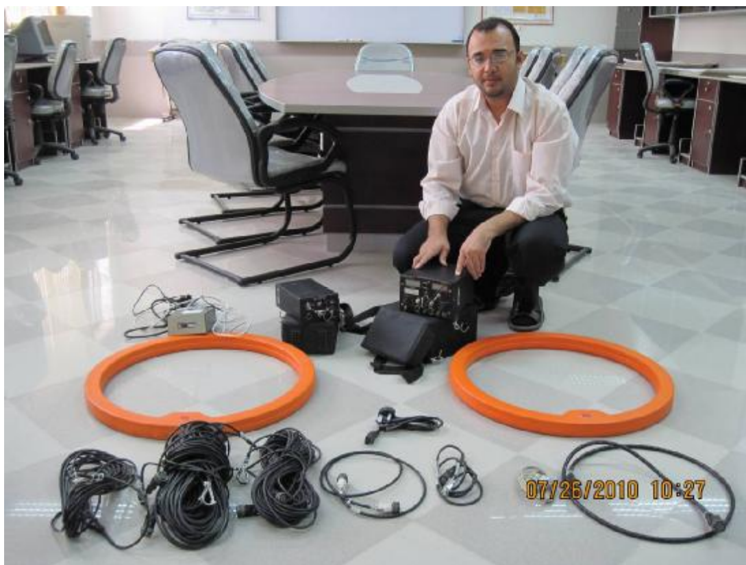
نمایی از دستگاه EM-34 به همراه متعلقات آن در مجموعه آزمایشگاههای ژئوفیزیک دانشگاه صنعتی شاهرود
