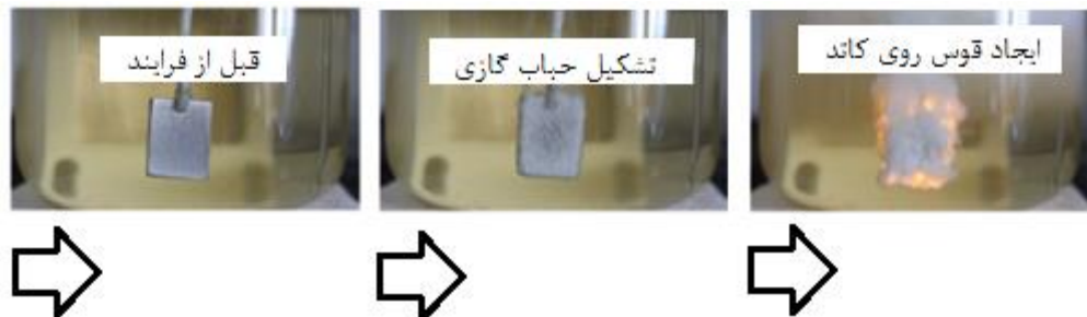
شکل ۲-۱۳) مراحل مختلف فرایند پوشش دهی CPED روی کاند [۲۵].
