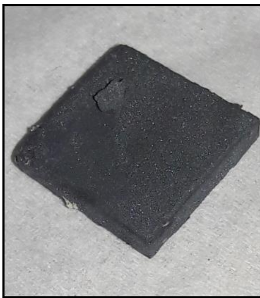
شکل ۴-۱۲) تصویر پوشش کنده شده در اثر خوردگی داغ.
