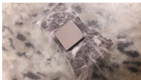
شکل ۱-۳) سطح آماده‌شده‌ی نمونه فولاد زنگ نزن ۳۱۶L جهت پوشش دهی.
