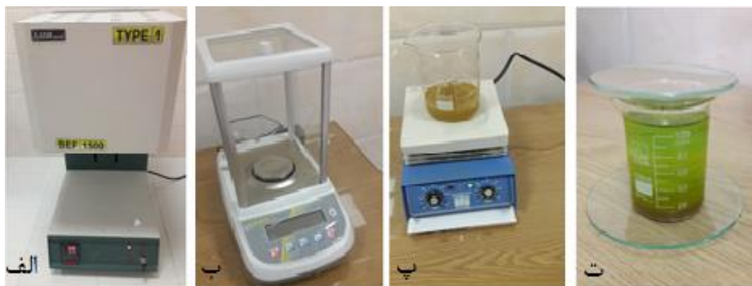
شکل ۳-۵) تجهیزات به کاررفته در آزمون خوردگی داغ.
