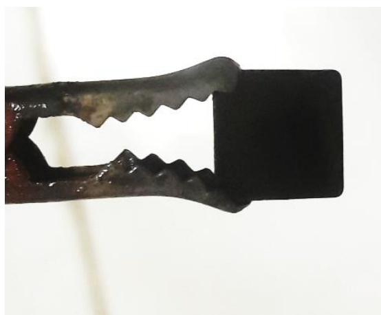
شکل ۲-۴) نمونه‌ی آزمایشی با پوشش کامل و یکنواخت در حالت مطلوب نگه‌دارنده‌ها.
