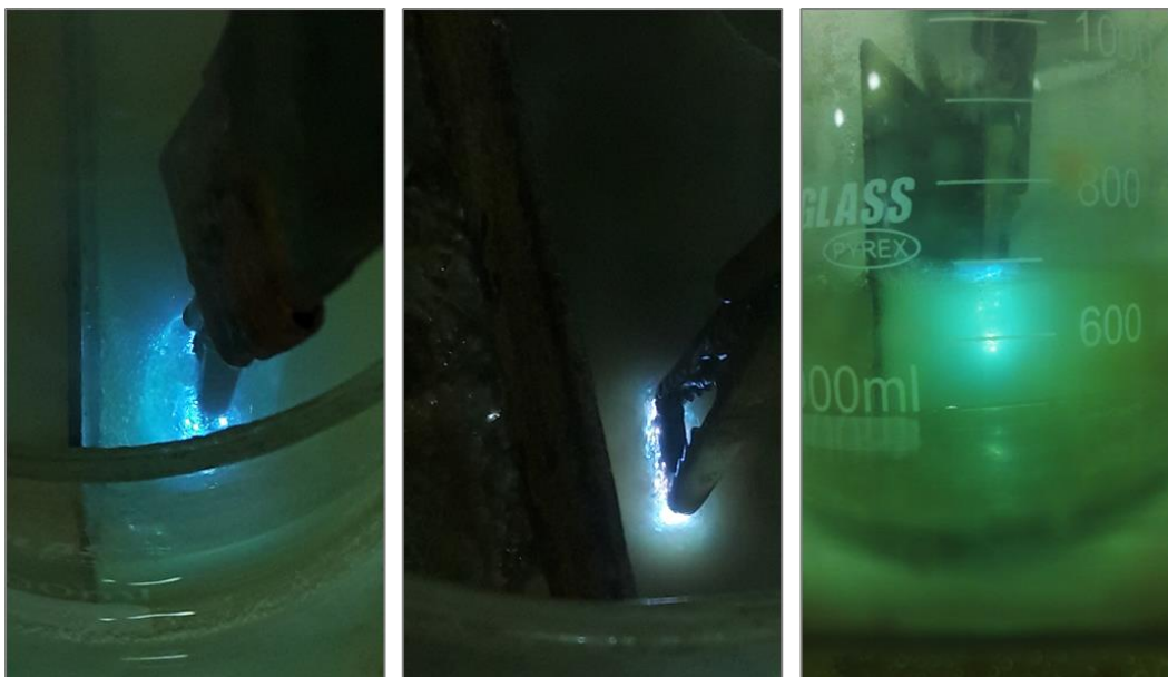
شکل ۳-۳) تصویر پلاسمای آبی رنگ تشکیل شده در فرایند CPED.
