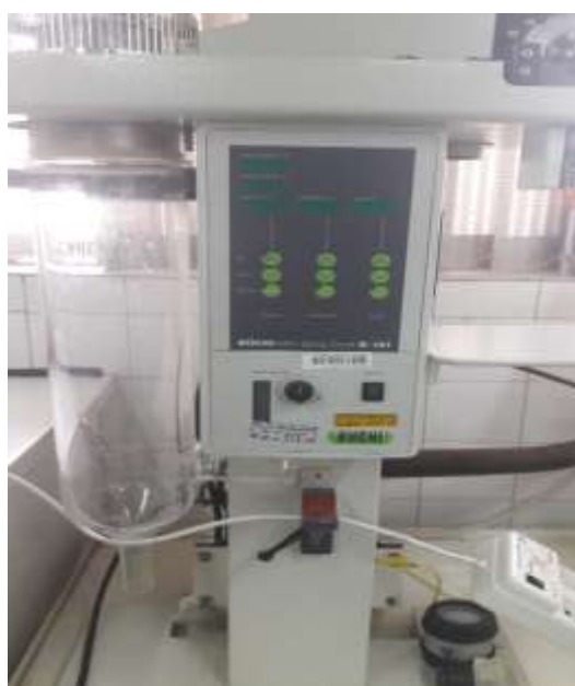
شکل ۲-۲- دستگاه خشک کن پاششی به منظور گرانوله کردن پودرها
