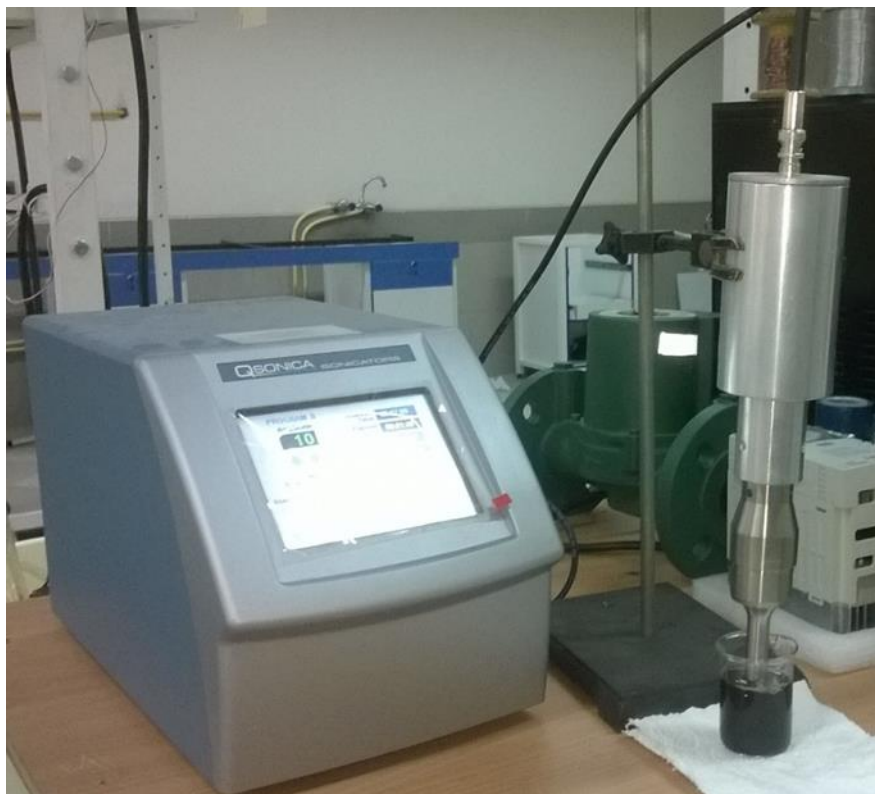
شکل ۳-۳- دستگاه فراصوت میله‌ای Qsonica Q700
