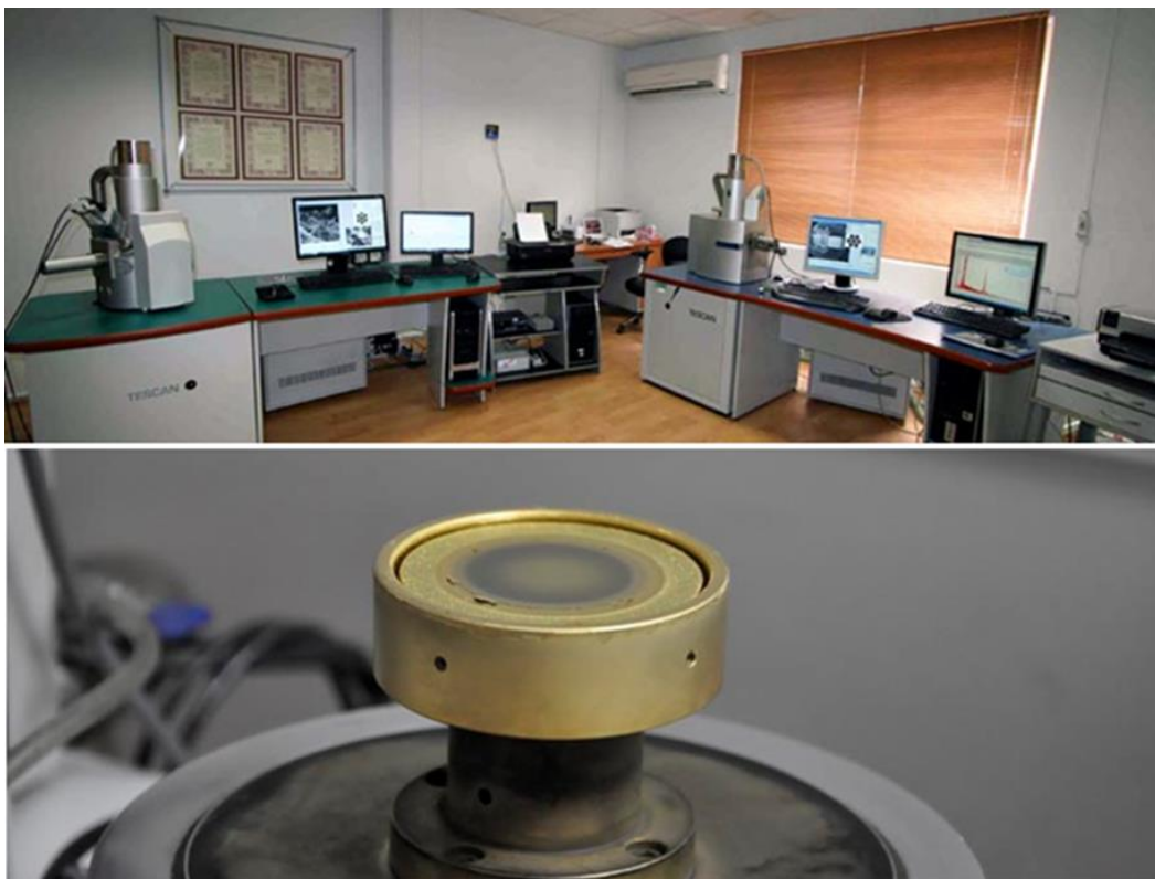
شکل ۳-۱۶- میکروسکوپ الکترونی روبشی و نمونه نگهدار آن
