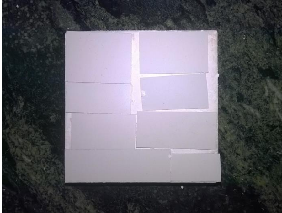
شکل ۳-۷- نمونه‌ی خام ZTA- 0.01 wt.% MWCNT- 1600 °C- 7 h
