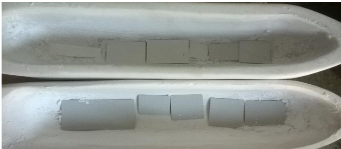
شکل ۳-۸- نمونه‌ی خام ZTA- 0.01 wt.% MWCNT- 1600 °C- 2 h
