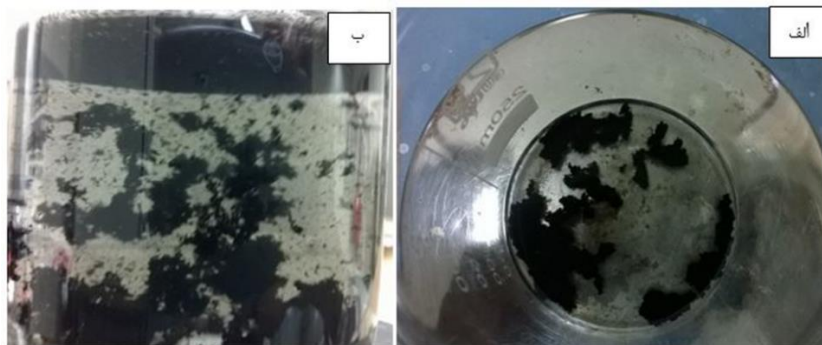
شکل ۲-۴ الف) درون اتانول در حال خشک شدن روی همزن مغناطیسی ب) درون اسید سولفوریک غلیظ و اسید نیتریک غلیظ به نسبت مساوی روی همزن مغناطیسی
