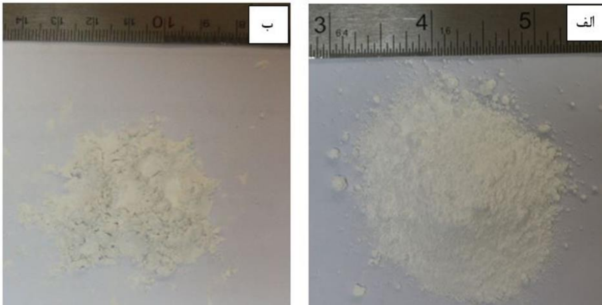
شکل ۳-۱- الف) پودر آلومینا ب) پودر 3YSZ
