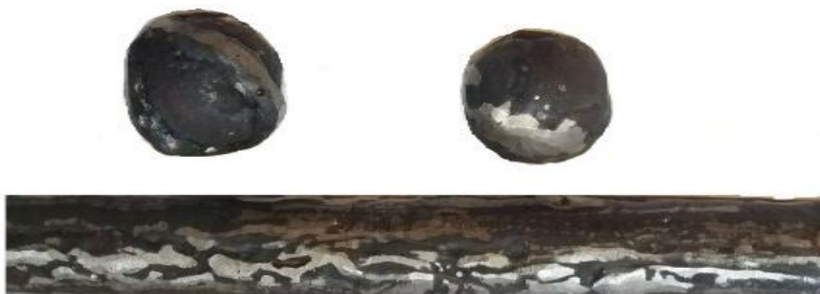
شکل ۳-۶: تصویر نمونه گلوله و لوله پوشش داده از نانوالیاز آنتروپی بالا
