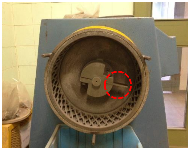
شکل ۳-۱۰: آزمایش اندازه گیری سایش مواد معدنی باند روی تیغه پوشش داده شده از نانو آلیاز آنتروپی بالا
