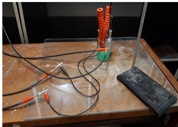
شکل ۳-۹: انجام آزمون‌های خوردگی توسط دستگاه (model Solartron analytical, SI-1287)
