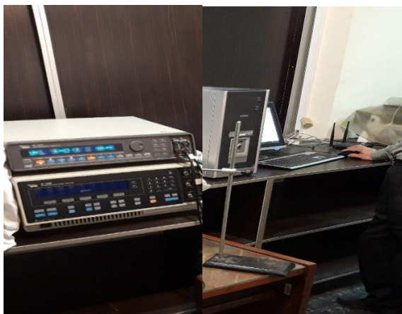
شکل ۳-۹: انجام آزمون‌های خوردگی توسط دستگاه (model Solartron analytical, SI-1287)
