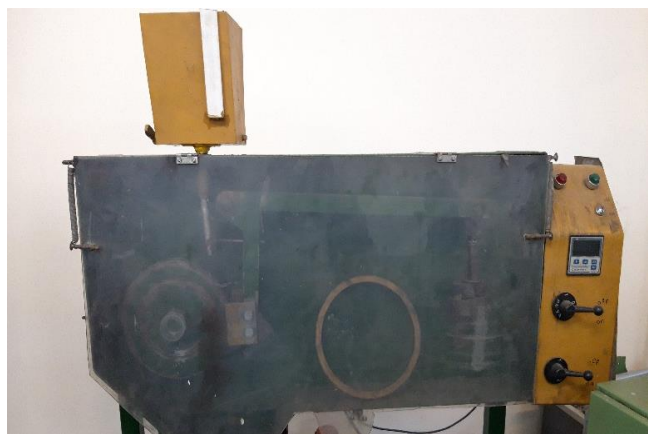
شکل ۳-۵: تصویر دستگاه استاندارد سایش ASTM G-65 و مشخصات دستگاه برای آزمون
