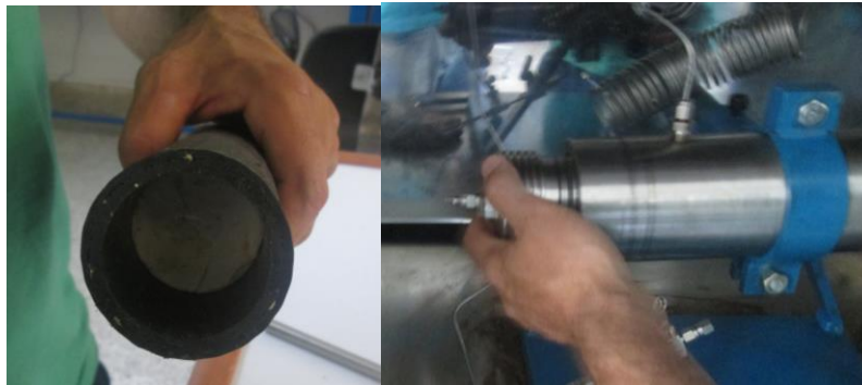
شکل ۳-۲۱: تعبیه نمونه داخل غلاف لاستیک نگهدارنده و سلول آزمایش
