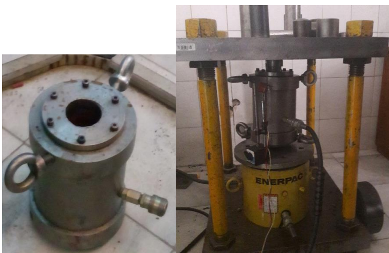
شکل ۳-۱۳: (الف) دستگاه آزمایش فشار سه محوری؛ (ب) سلول آزمایش سه محوره
