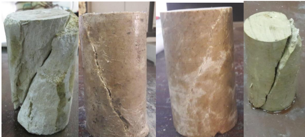
شکل ۳-۱۵: نمونه سنگ‌ها پس از آزمایش
