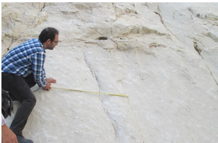
شکل ۶-۳: برداشت صحرایی ناپیوستگی‌های موجود در توده‌سنگ
