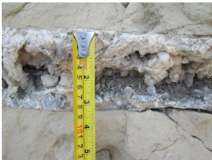
شکل ۴-۶: برداشت بازشدگی و مواد پرکننده شکستگی‌های موجود در رخنمون توده‌سنگ
