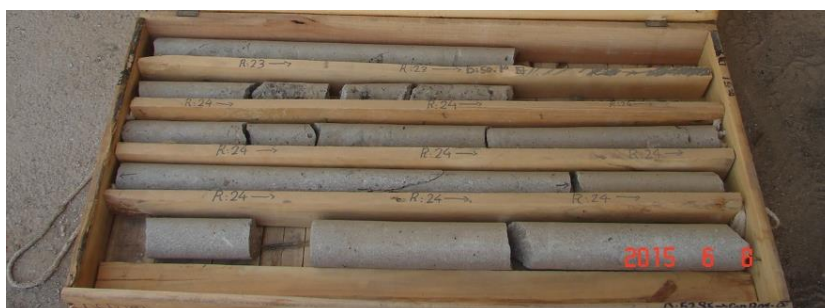
شکل ۱-۳: جعبه نمونه سنگ جهت انجام آزمایش
