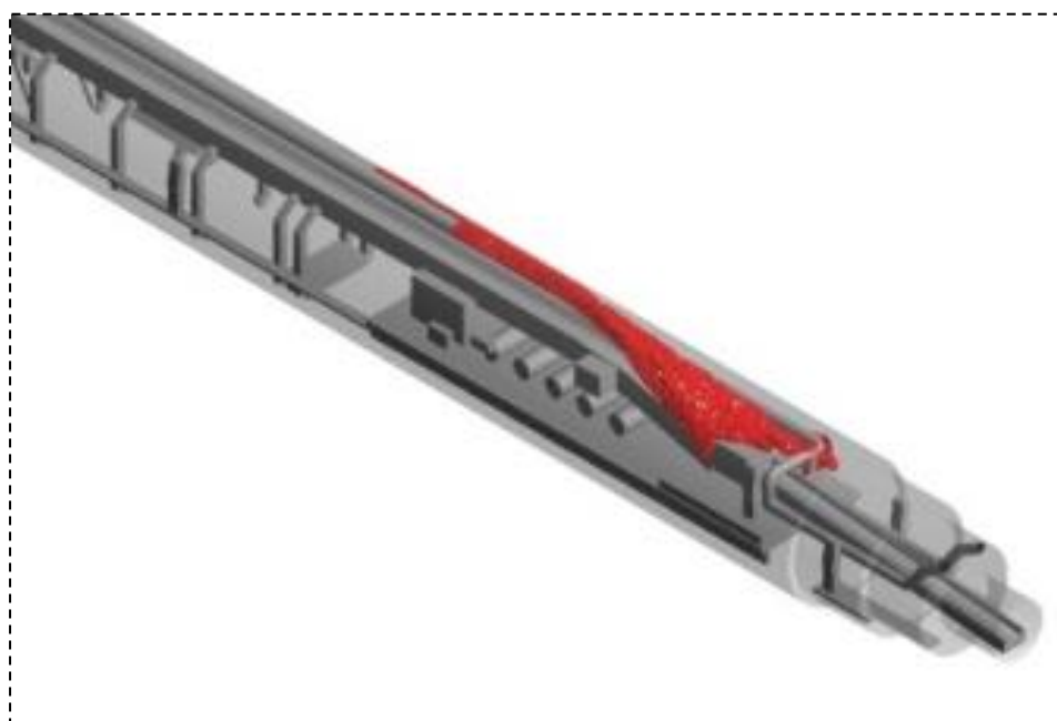
شکل ۴-۱۴- حجم منطقه با سرعت بیش از حد مجاز در شرایط نصب کامل مجرای تهویه از قسمت پشتیبان تا قاب اصلی ماشین و خاموش کردن بادبزن مکشی کمکی
