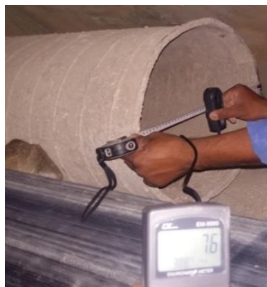
شکل ۲-۸- نمونه برداری دما و سرعت هوا توسط دستگاه بادسنج مینی پره‌ای
