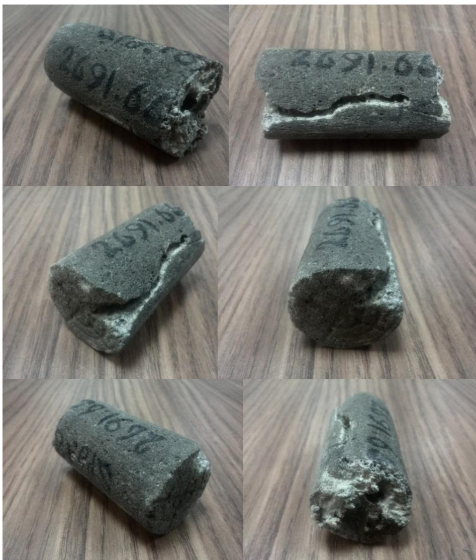
شکل ۶-۲۶. تصویر مغزه ۲۶۹۱/۶۶ بعد از عملیات اسیدزنی.
