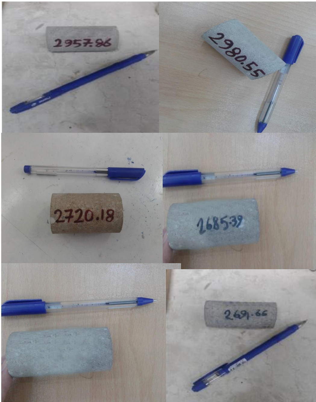
شکل ۶-۱. تصاویر مغزه‌های مورد آزمایش قبل از عملیات اسیدزنی.
