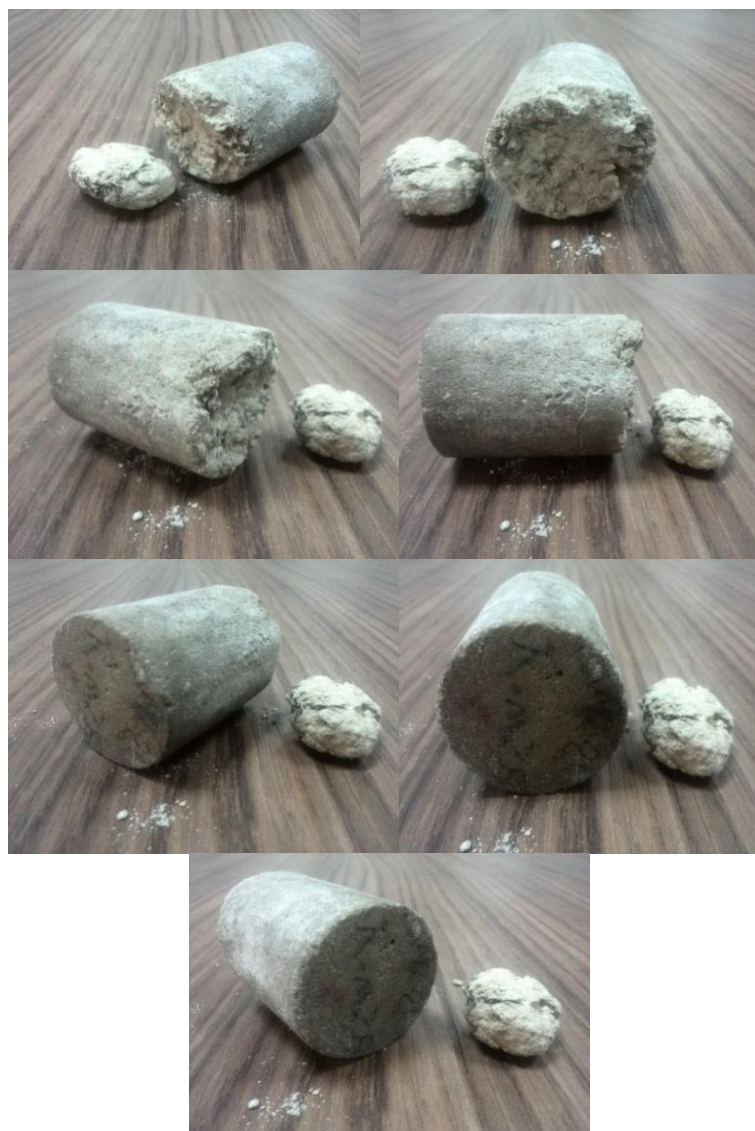
شکل ۶-۲۴. تصویر مغزه ۲۷۱۲/۱۹ بعد از عملیات اسیدزنی.
