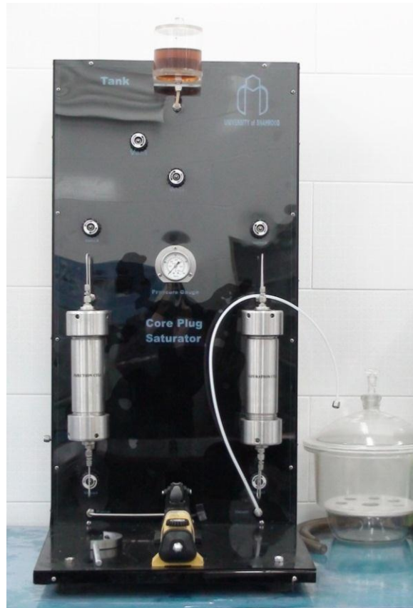
شکل ۵-۸. دستگاه اشباع مغزه.
