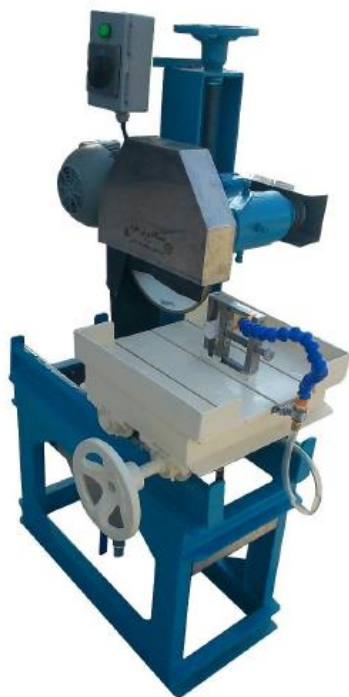
شکل ۵-۲. دستگاه برش دو سر مغزه مدل CC-R30.
