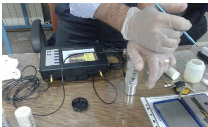
شکل ۵-۶. آزمایش تعیین سرعت عبور امواج.
