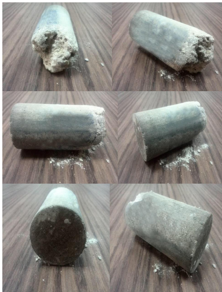
شکل ۶-۲۲. تصویر مغزه ۲۶۸۵/۳۹ بعد از عملیات اسیدزنی.
