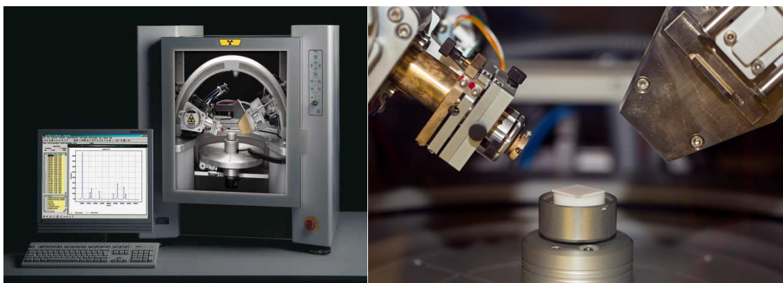
شکل ۵-۳. دستگاه XRD یا پراش پرتو ایکس.
