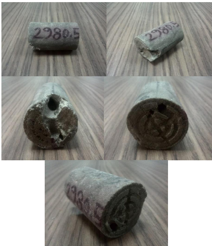
شکل ۶-۱۸. تصویر مغزه ۲۹۸۰/۵۵ بعد از عملیات اسیدزنی.
