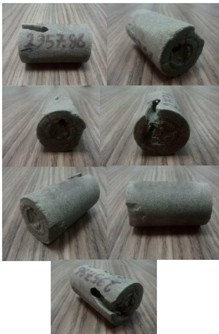
شکل ۶- ۱۶. تصویر مغزه ۲۹۵۷/۸۶ بعد از عملیات اسیدزنی.
