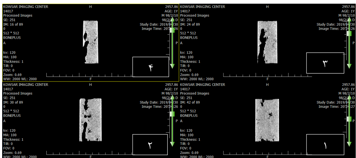
شکل ۶- ۴۳. تصویر سی تی اسکن برش‌های مغزه ۲۹۵۷/۸۶ عمود بر محور Z بعد از عملیات اسیدزنی.
