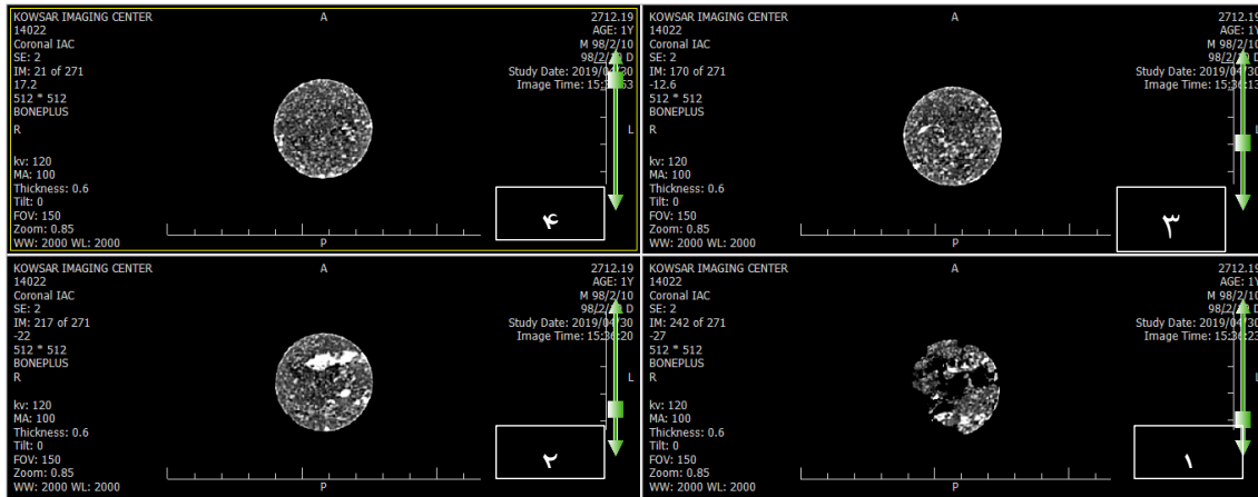
شکل ۶-۵۳. تصویر سی تی اسکن برش‌های مغزه ۲۷۱۲/۱۹ عمود بر محور X بعد از عملیات اسیدزنی.
