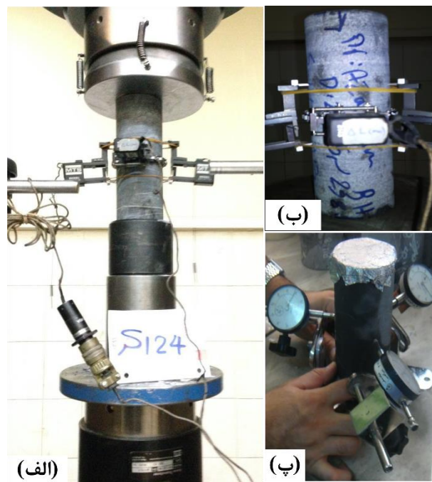
شکل ۴-۲. (الف) جک آزمایش (ب) کرنش سنج های الکتریکی (پ) تغییرشکل سنج های مکانیکی
