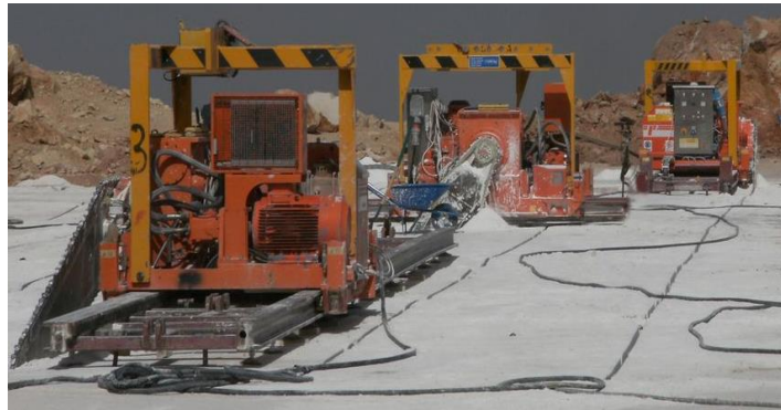
شکل ۲-۱۹: ماشین اره زنجیری در حال برش سنگ با زاویه ۷۵ درجه
