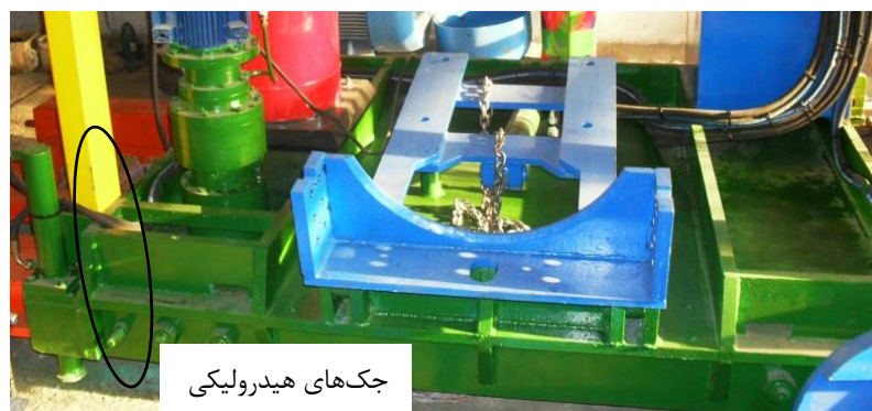
شکل ۲-۷: شاسی و جک‌های هیدرولیکی که در تصویر مشخص شده‌اند
