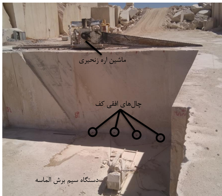
شکل ۲-۲۰: عملیات همزمان حفاری چال افقی و برش سنگ توسط ماشین اره زنجیری
