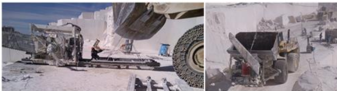
شکل ۲-۱۷: حمل ماشین و تراز کردن ریل‌ها
