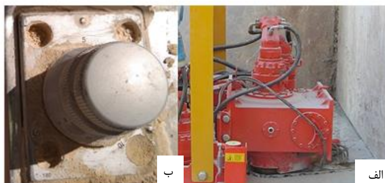
شکل ۲-۸: موتور تیغه؛ (الف) گیربکس حرکت بازو؛ (ب) اهرم تنظیم حرکت بازو
