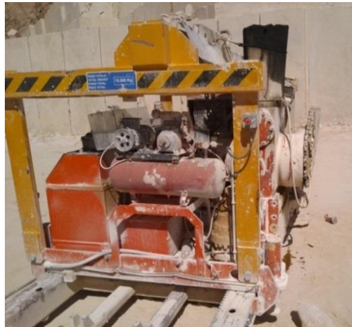
شکل ۲-۵: ماشین اره زنجیری و اجزای آن
