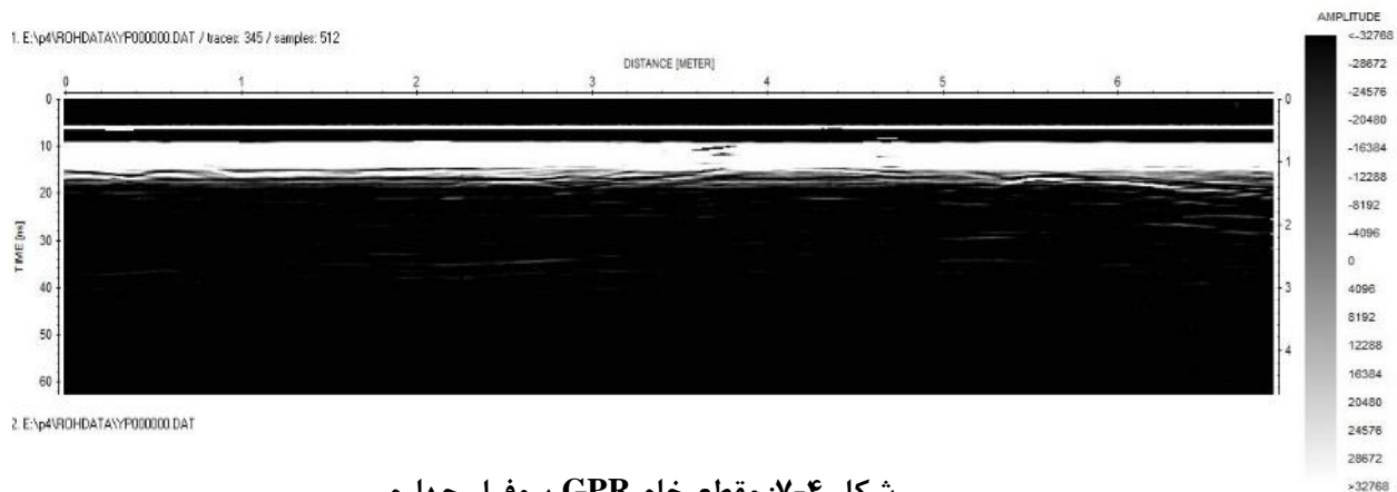
شکل ۴-۷: مقطع خام GPR پروفیل چهارم
