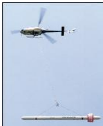
شکل (۳-۶): روش برداشت هلی کوپتری سیستم DIGHEM. [www.fugro.com]
