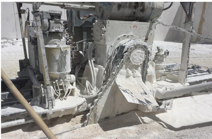
شکل ۲- ۲۱ برش عمودی در استخراج معادن سنگ ساختمانی به روش ماشین برش اره زنجیری
