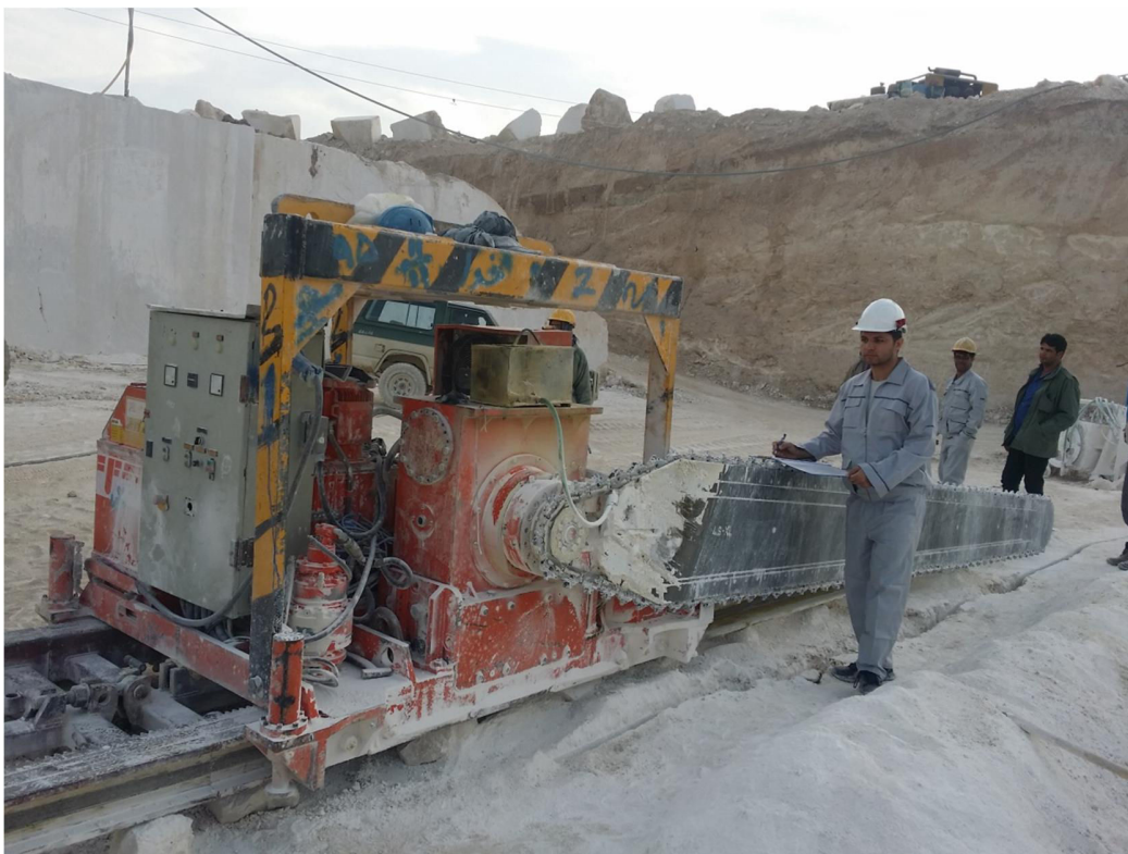
شکل ۳-۴ ماشین برش اره زنجیری مورد استفاده در معدن مورد مطالعه
