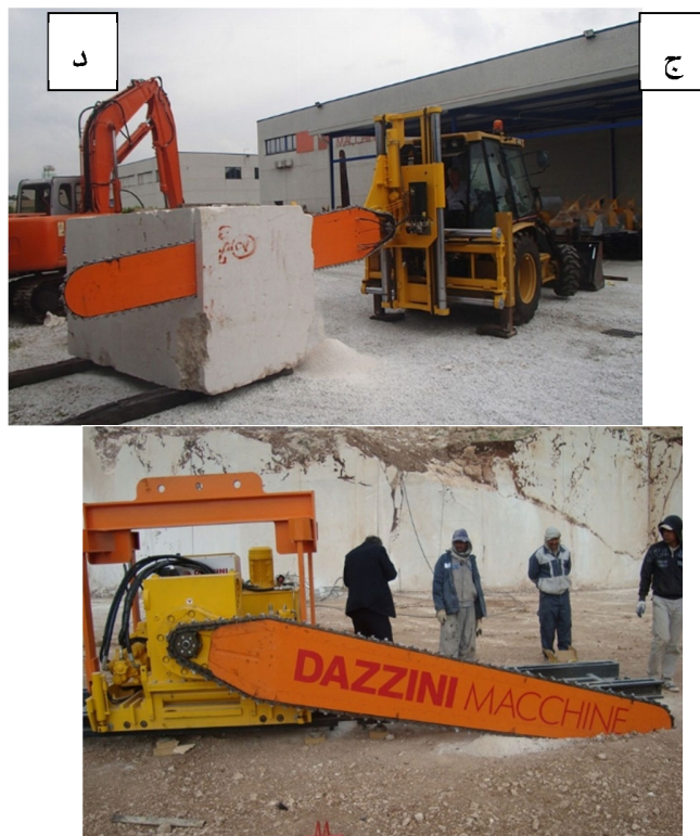
شکل ۲-۱۰ مدل های تولیدی ماشین اره زنجیری توسط شرکت دزینی (www.Dazzinimacchine.com) الف- مدل QS8000D ب- مدل QS6000D ج- مدل QS4000D د- مدل QST3000D
