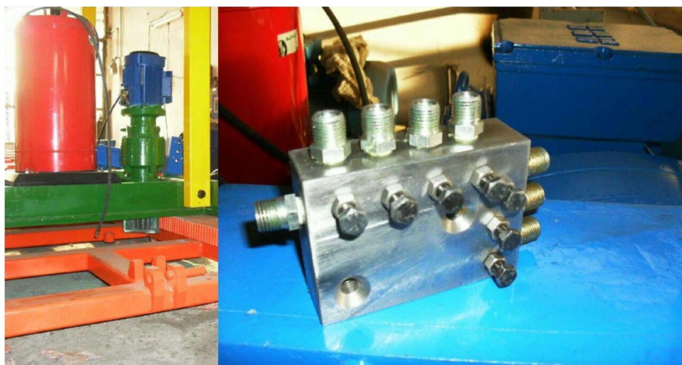
شکل ۲-۱۹ نمایی از کمپرسور با دو سیستم گریسکاری اتوماتیک
