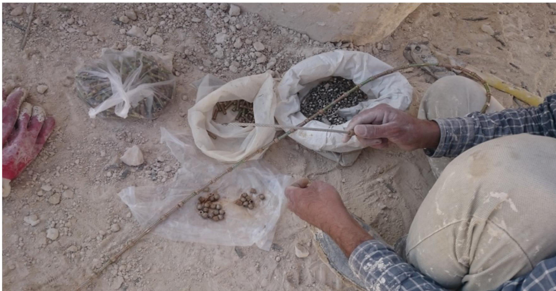
شکل ۲-۳ نصب سگمنت های الماسه روی سیم فولادی توسط اپراتور در معدن شورجه رباط واقع در استان مرکزی
