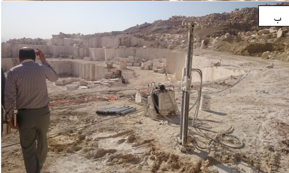
شکل ۲-۴ الف- حفر چال افقی توسط دستگاه راسل در معدن تراورتن شوره رباط ب- حفر چال عمودی توسط دستگاه راسل در معدن تراورتن حاجی آباد واقع در استان مرکزی
