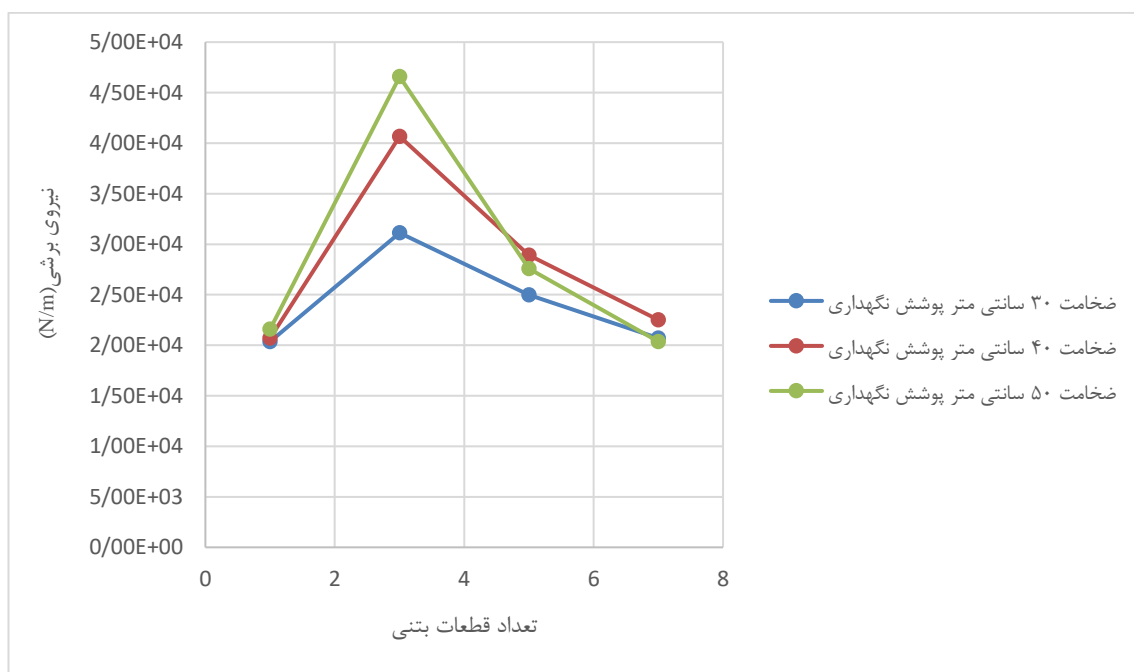
شکل (۳-۲۹) نمودار تنش برشی - تعداد قطعات بتنی برای خاک GW متراکم
