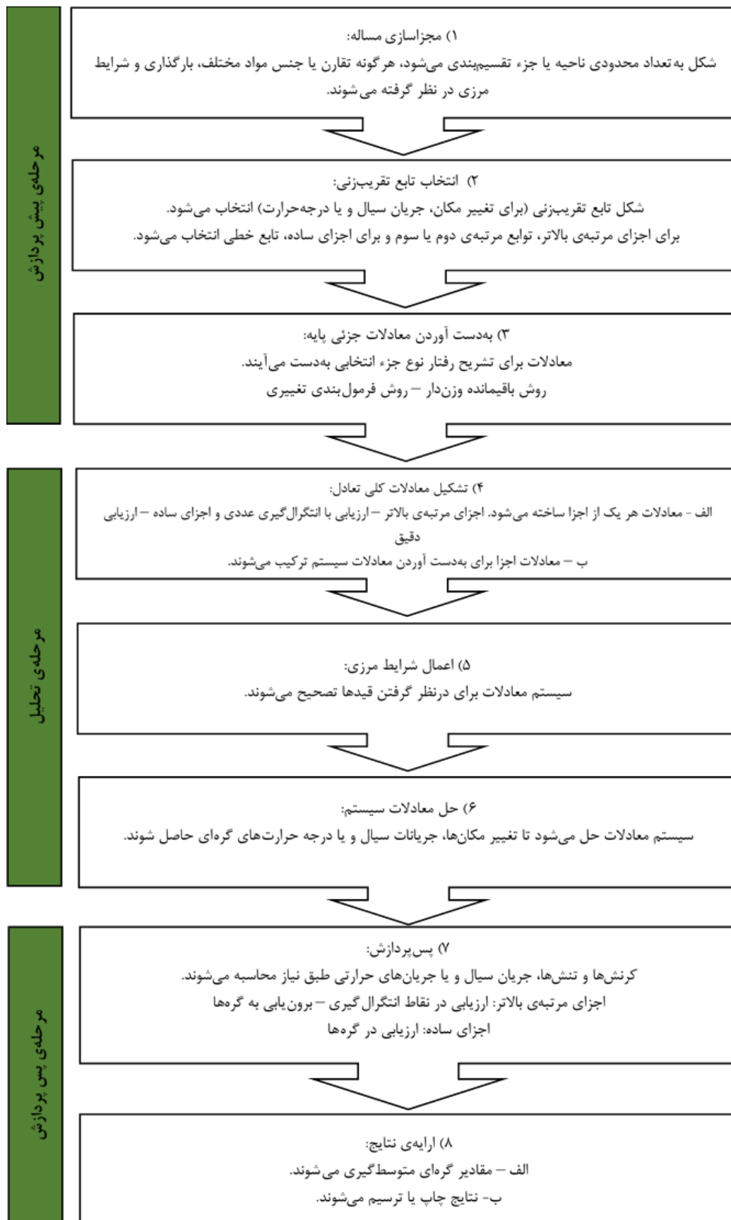
شکل ۳-۱۴ مراحل کلی روش اجزای محدود [۹۶]
