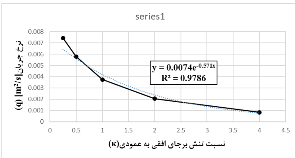
(ب) نمودار نسبت مؤلفه‌ی افقی به قائم میدان تنش برجا در برابر میانگین نرخ جریان DFN
