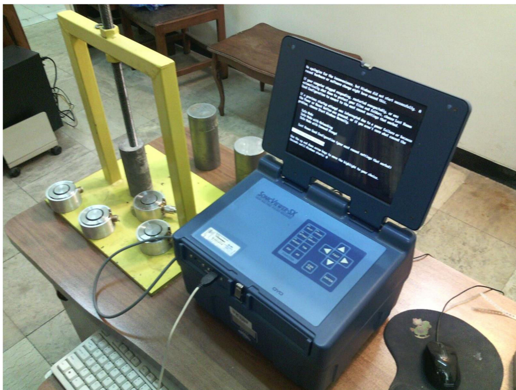
شکل ۳-۶ تجهیزات انجام آزمایش تعیین سرعت صوت شامل ژنراتور مولد پالس و اسیلوسکوپ نمایش موج و رارسان‌ها، کابل‌های رابط و نمونه کامپوزیتی
