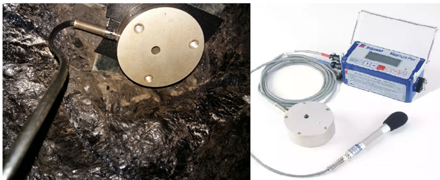
شکل ۲-۴ ابزار رفتارنگاری لرزش‌های انفجاری و ژئوفون نصب شده در سقف کارگاه
