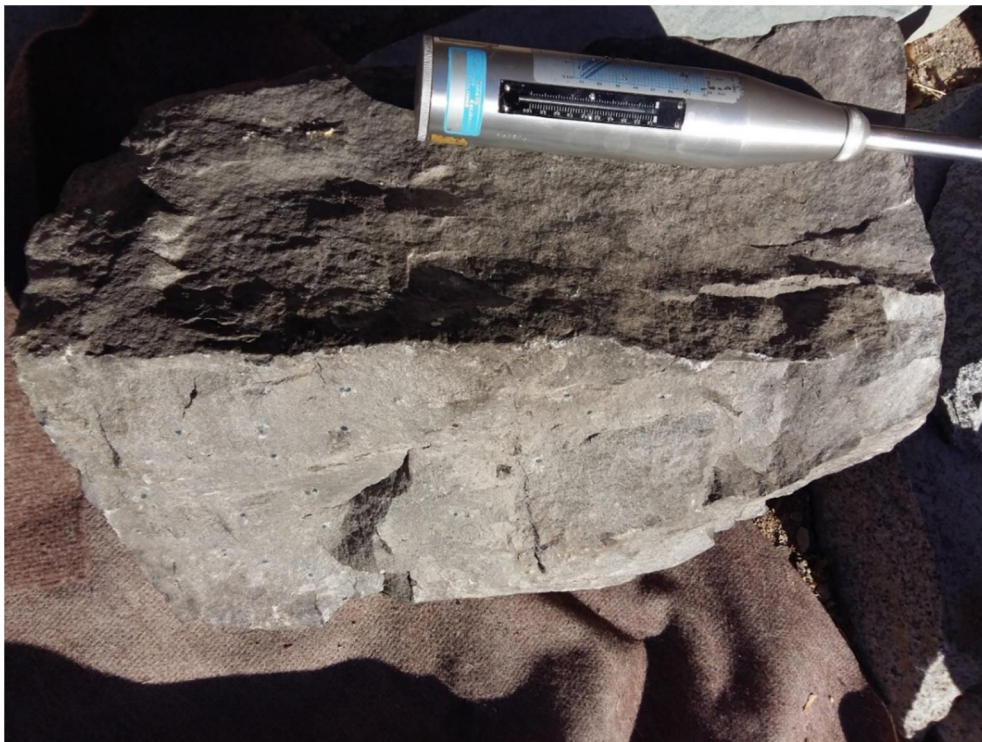
شکل ۳-۵ چکش اشمیت به همراه یکی از بلوک های مورد آزمون
