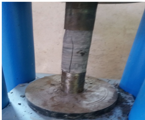
شکل ۳-۷ تعیین مقاومت تک‌محوره سنگ (مغزه تحت اعمال نیرو)
