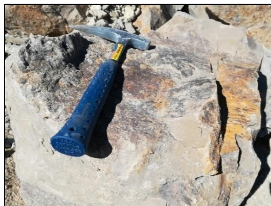
شکل ۱ بخش توفی با ریزدانه‌های کالکوپیریت
