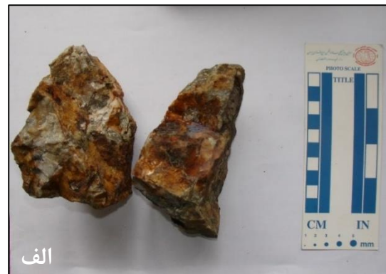
شکل ۶-۲۰ الف) کانه‌زایی گالن، پیریت، کالکوپیریت، بورنایت، مالاکیت و لیمونیت. ب) کانه‌زایی مس.
