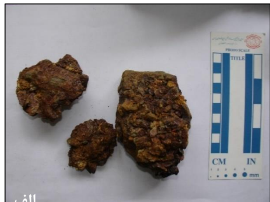
شکل ۶-۲۴ الف) اکسید آهن دانه درشت. ب) کانه‌زایی مالاکیت و اکسید آهن دانه‌ریز.
