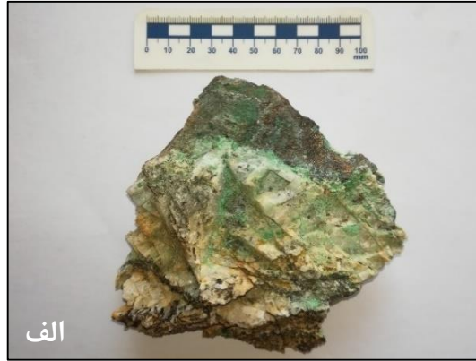
شکل ۶-۱۵ الف) کانه‌زایی مس مالاکیتی و کالکوپیریت و اکسید آهن. ب) آلتراسیون اکسید آهن.
