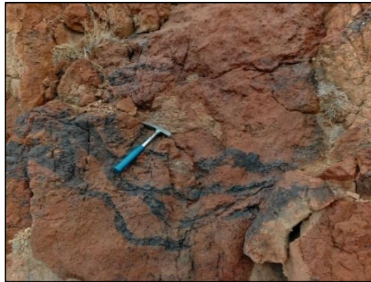
شکل ۹۹ رگه‌های آهن‌دار موجود در آهک‌ها
