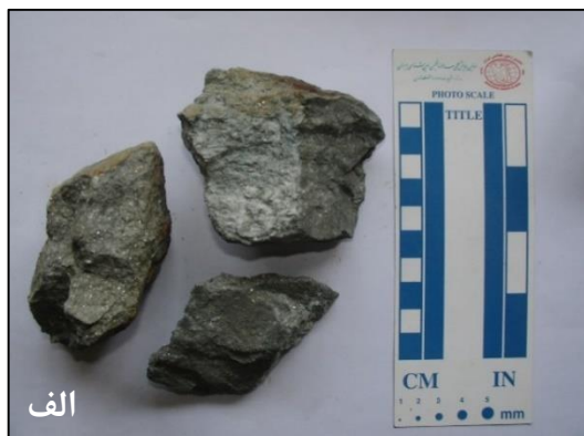
شکل ۲۵-۶ الف) پیریت و کالکوپیریت توده‌ای. ب) کانه‌زایی ملاکیت به همراه منگنز.
