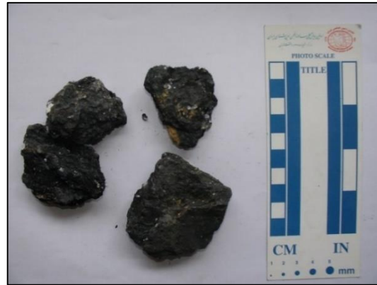
شکل ۱۵۳ همراهی پیریت و کالکوپیریت فراوان در نمونه‌ها
