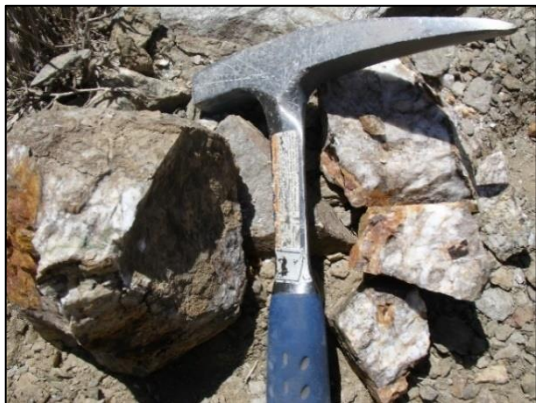
شکل ۱۲۲ اکسید آهن در رگه‌های سیلیسی
