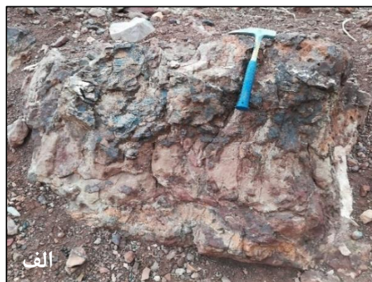
شکل ۶-۱۷ (الف) آغشتگی آهن. (ب) توالی لیتولوژی‌های مختلف.
