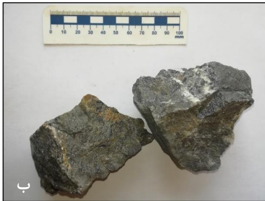
شکل ۹-۶ الف) لنزهای هماتیته بر روی آهک‌ها و متاولکانیک‌ها. ب) کانه‌زایی کالکوپیریت در یک متاولکانیک.
