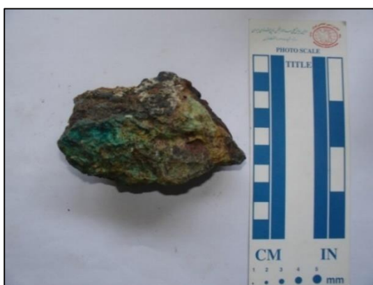
شکل ۱۳۱ کانه‌زایی ملاکیت و اکسید آهن دانه‌ریز
